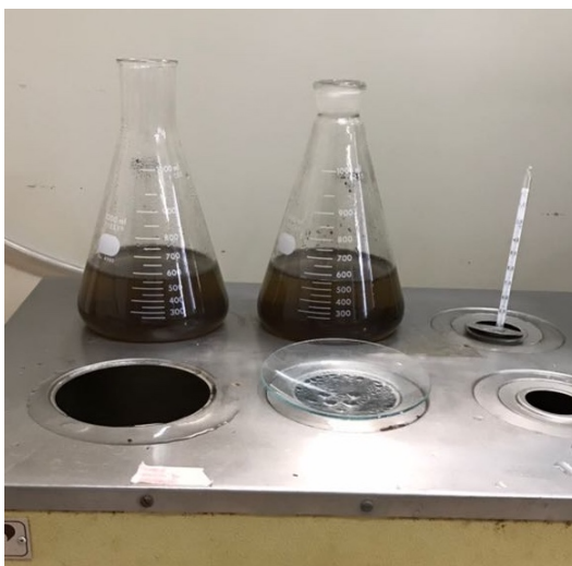
Figura 3.9: Etapa intermediária do ensaio de determinação do teor lignina. Fonte: AUTORA, 2019.
