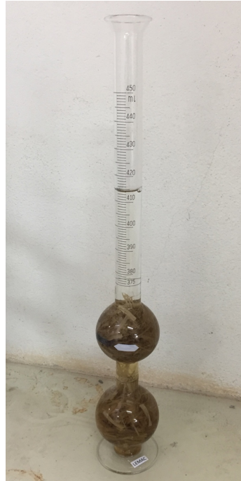
Figura 3.5: Determinação da massa específica das fibras de Curauá. Fonte: AUTORA, 2019.
