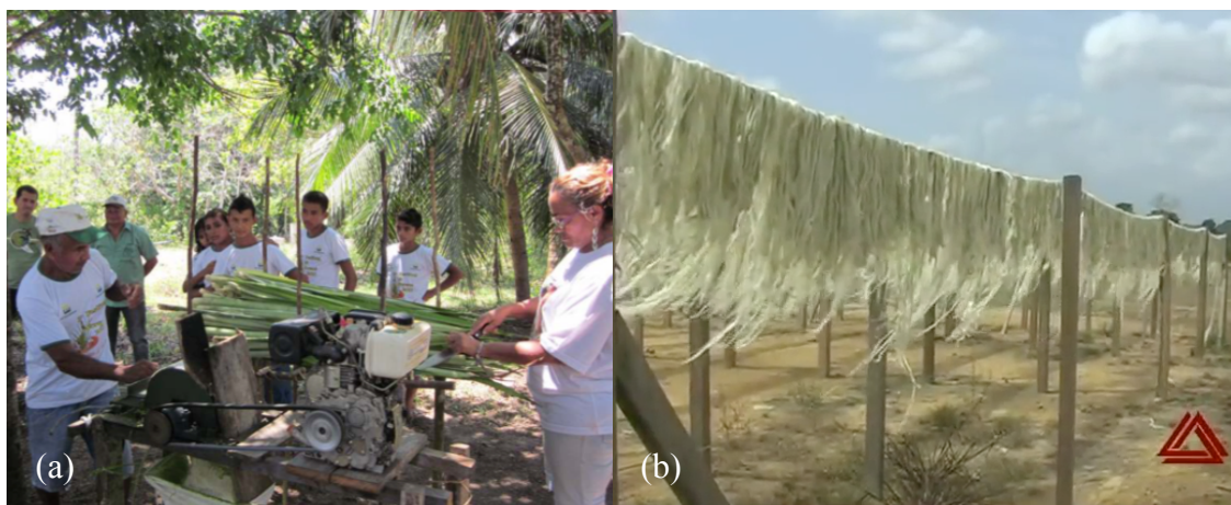
Figura 2.5: Beneficiamento das fibras de curauá. (a) Decorticação, (b) Secagem das fibras. Fonte: CEAPAC e PEMATEC, 2017.
