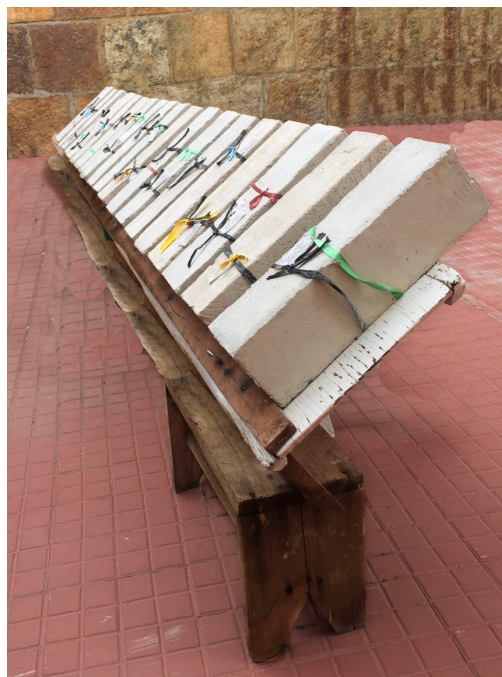
Figura 3.16: Envelhecimento natural dos corpos de prova prismáticos. Fonte: AUTORA, 2019.
