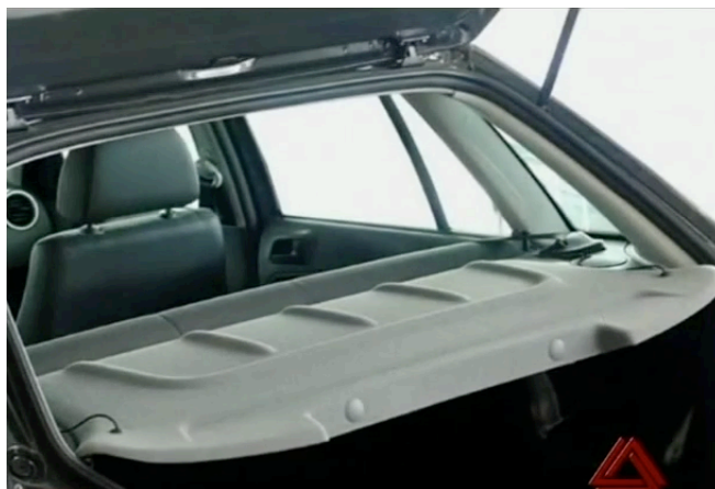
Figura 2.7: Tampa de porta malas produzido com compósitos de curauá. Fonte: PEMATEC, 2017.
